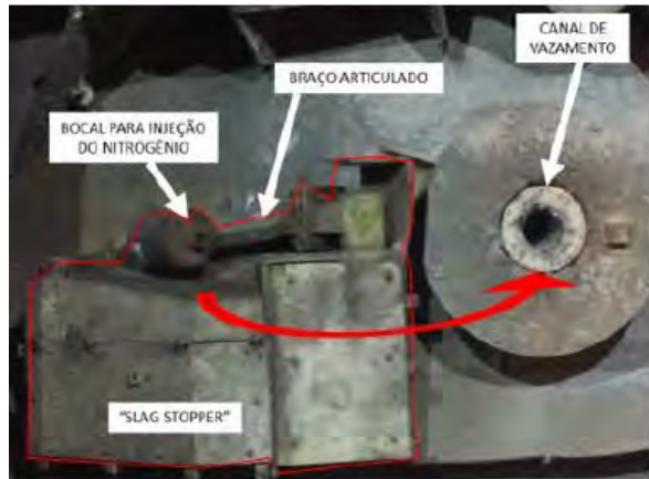
DEMONSTRAÇÃO ESQUEMÁTICA DO "SLAG STOPPER" EM OPERAÇÃO
